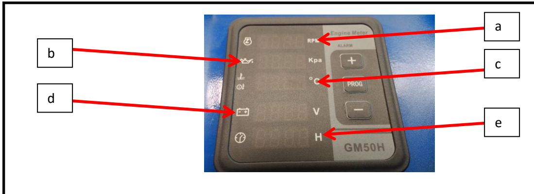
Figura: 3 panel de indicadores y tacómetros (a: indicador de revoluciones del motor / b: indicador de presión de aceite / c: temperatura / d: voltaje del acumulador / e: Hodómetro)
